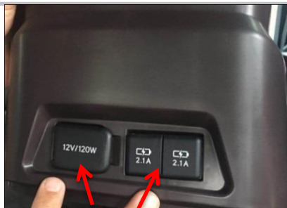
1.22 把点烟器和 USB 安装在净化器上
