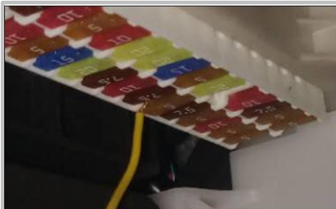
2.10 接 ACC：取出原车保险丝，将我们线束黄色线缠绕在原车 ECU-ACC 保险,5A 保险丝上再插入原位即可，接至保险丝左侧
