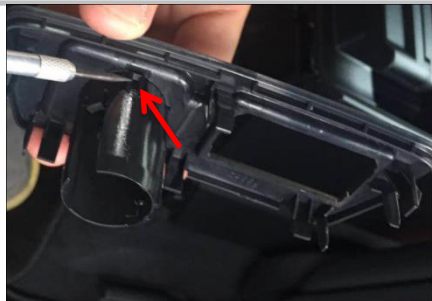
1.15 翘起卡扣，拆下点烟器底座
