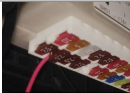
2.8 接正极带电：取出原车保险丝，将我们线束红色线缠绕在原车 OBD 保险,7.5A 上再插入原位即可，接至保险丝左侧
