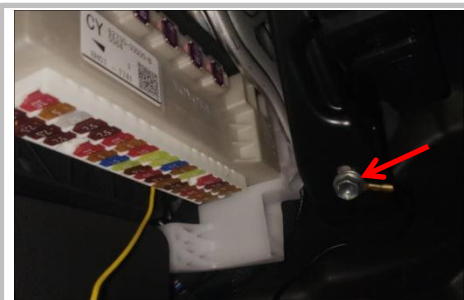
2.11 负极：在连接器附近位置看到不带油漆的螺栓柱，装上连接片拧紧；（箭头）
