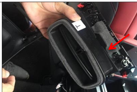
1.6 拆空调出风装饰件（如箭头），拆件步骤如下
