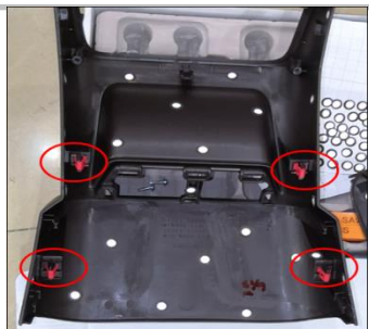
1.18 取出原车四个塑料卡扣，对应安装在净化器上
