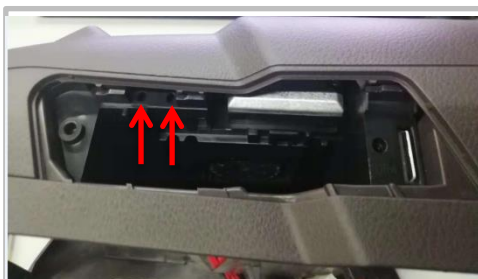
1.27 APP 解绑和滤芯重置在箭头指示方向
