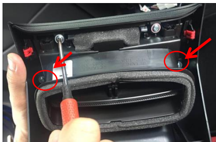
1.7 用十字螺丝刀将螺丝拧下（如箭头位置）
