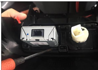
1.11 取出USB和点烟器的安装板,翘起原车此处卡扣
