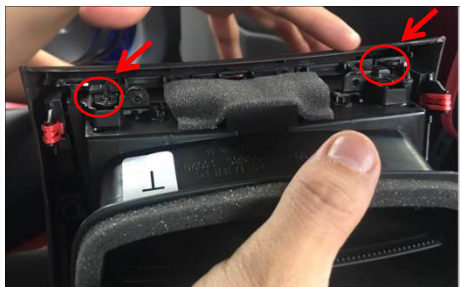
1.19 将空调出风装饰件通过卡扣固定在我司净化器，（箭头位置）
