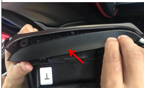
1.20 将小装饰件（箭头）安装在我司净化器
