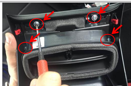
1.21 将原车拆下来的四个自攻钉固定空调出风装饰件
